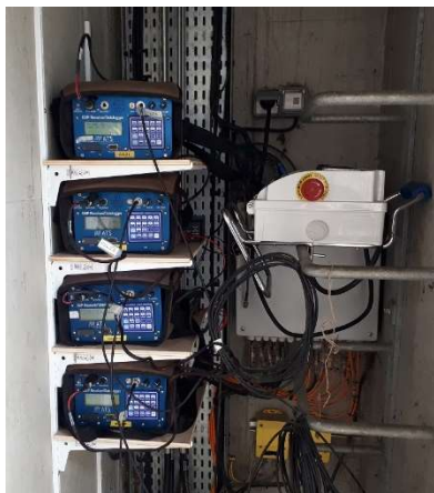
Photo 25 : Exemples d'installation de récepteur-enregistreurs utilisés à Golfech (à gauche) et au Bazacle (à droite)
