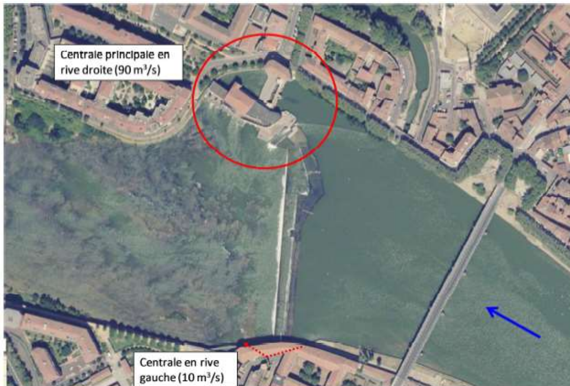
Photo 12 : Vue aérienne du barrage du Bazacle au cœur de Toulouse (source : Géoportail)
