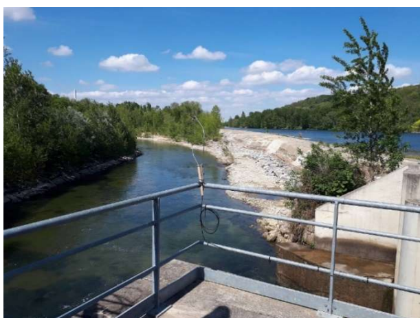
Photo 29 : Antenne aval (antenne boucle) installée à l'entrée de la passe à poissons de l'usine de la Cavaletade
