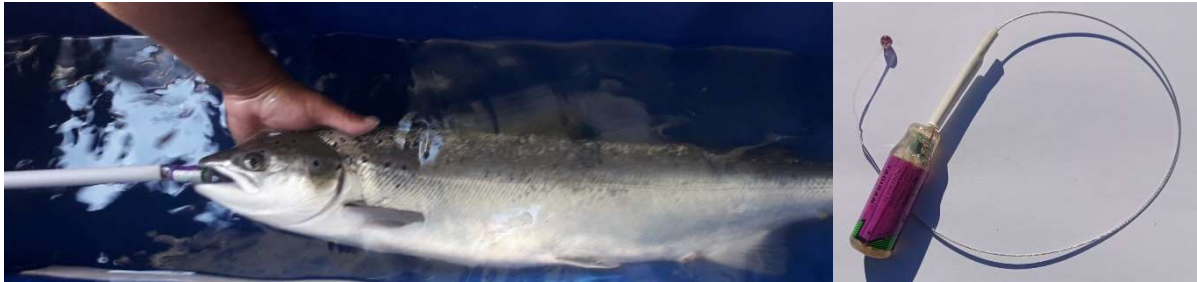
Figure 83 : marquage intra-gastrique d'un saumon à l'aide d'un émetteur radio couplé à une marque TIRIS
