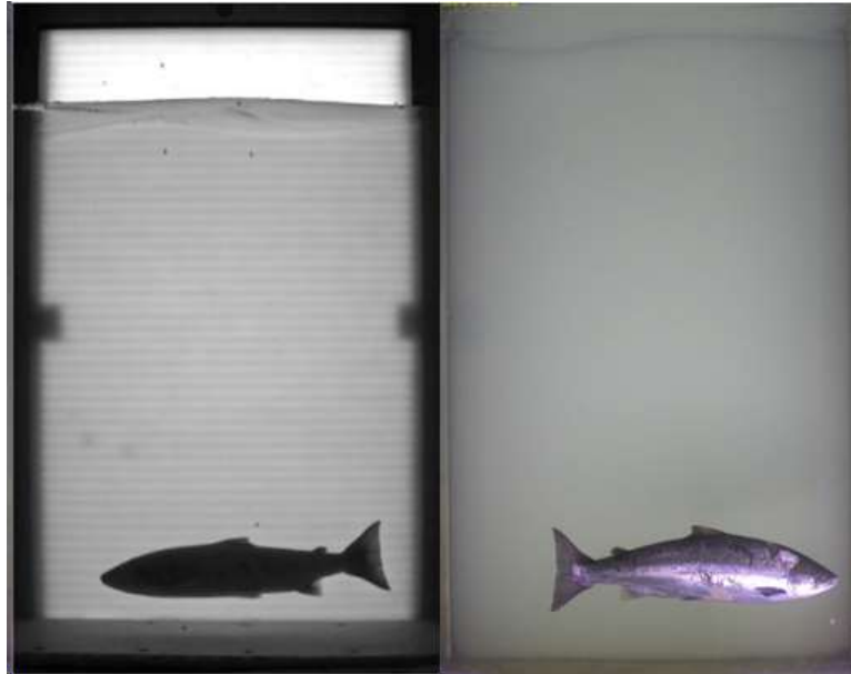
Figure 53 : Images de saumons obtenus via deux types d'éclairages (rétro-éclairage à gauche et direct à droite)
