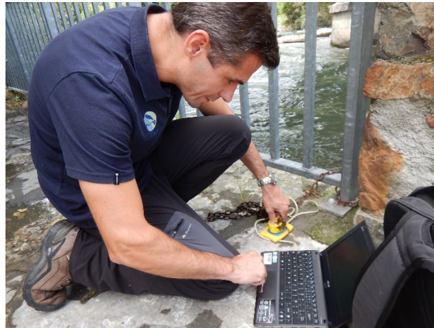
Récupération des données enregistrées par une sonde de température
