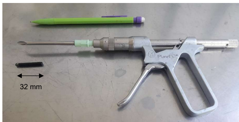
Photo 19 : Tag RFID de 32 mm et son pistolet de marquage
