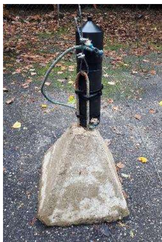
Photo 26 : Exemples d'installation d'hydrophone avec son lest
