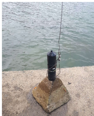
Photo 26 : Exemples d'installation d'hydrophone avec son lest
