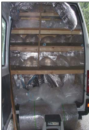
Figure 4 : Camion isotherme pour le transport des larves en sac.
