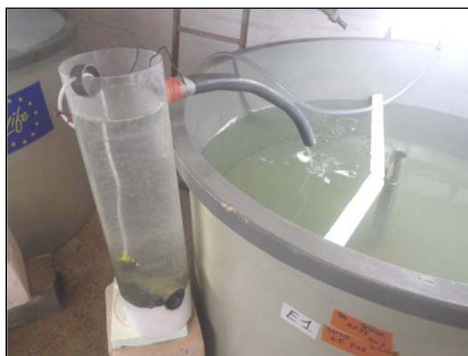
Figure 20 : Dispositif d'éclosion des œufs et de transfert dans les bacs d'élevage.
