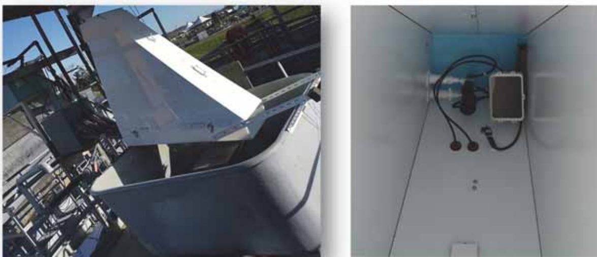
Figure 62 : Photo du système de comptage vidéo Hizkia.
